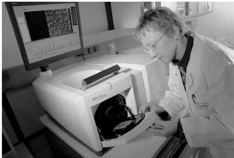
Les images sont ensuite traitées par un logiciel qui déduit la séquence de bases correspondantes. Jusqu'à 1,2 millions de séquences uniques peuvent être produites en une seule analyse grâce au nouveau séquenceur Roche GS FLX Titanium., correspondant à 500 millions de nucléotides par run.
